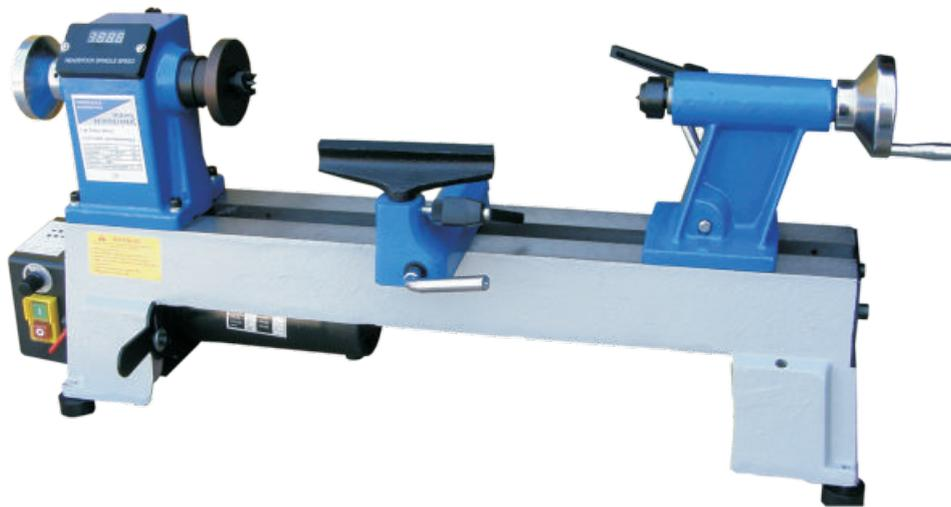
Drehelbett, Untergestell Reitstock und Spindelstock aus massivem Grauguss
